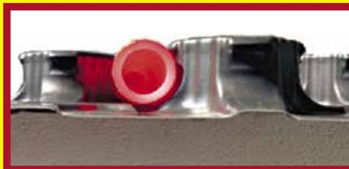
В Отличии от конкурентных плит, при укладке труб можно использовать бобышку, как опору для загиба труб. Трубу не нужно предварительно загибать, а затем укладывать ее в пазы. Получается значительная экономия времени при укладке труб.
